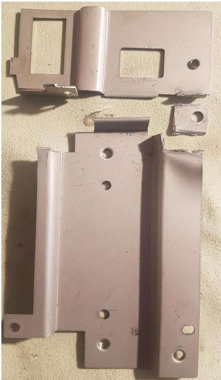
Se hacen 3 agujeros en la carcasa del MSX para instalar los tornillos que sujetaran la fuente de alimentación nueva.
